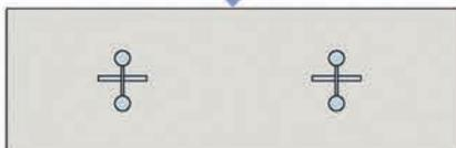
La concezione progettuale dei connettori a taglio Staifix in due distinte componenti, spinotto e manicotto, elimina la necessità di forare in cantiere le casseforme e permette di realizzare in modo semplice e con la massima accuratezza l'allineamento spinotto-manicotto.
