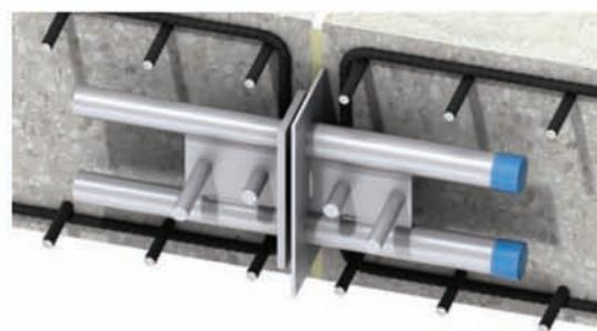
1. Inchiodare il manicotto al cassero mediante la sua piastra di fissaggio prima di posare l'armatura, avendo cura di posizionarlo correttamente rispetto alla direzione del carico (vedi foto a lato).
