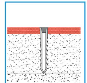
3 Completare l'inserimento del profilo utilizzando un martello in gomma
