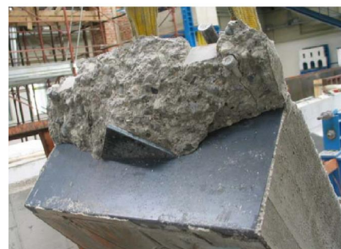
Collasso del provino con giunto Joint tipo H
