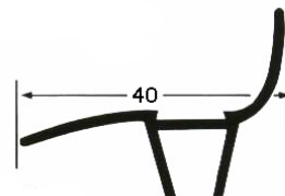
W 50-KFE 250/31 Duralluminio Versione ad angolo (per parete)
